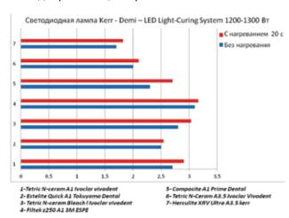
**Рис. 5.** График глубины полимеризации композитов при использовании светодиодной лампы Demi – LED Light-Curing System «Kerr»
