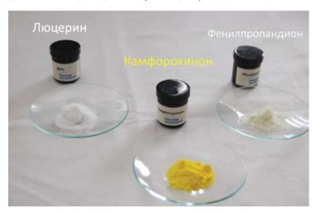
Рис. 2. Фотоинициаторы, используемые в фотокомпозитах
