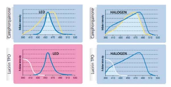
Рис. 1. График диапазона поглощения длин волн фотоинициаторами в зависимости от источника излучения
