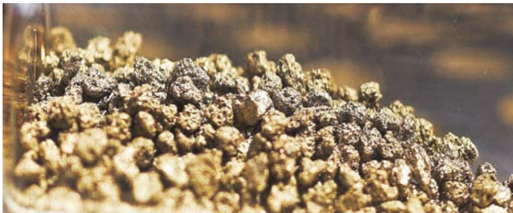
Рис. 1. Гранулы нерезорбируемого пористого титана
