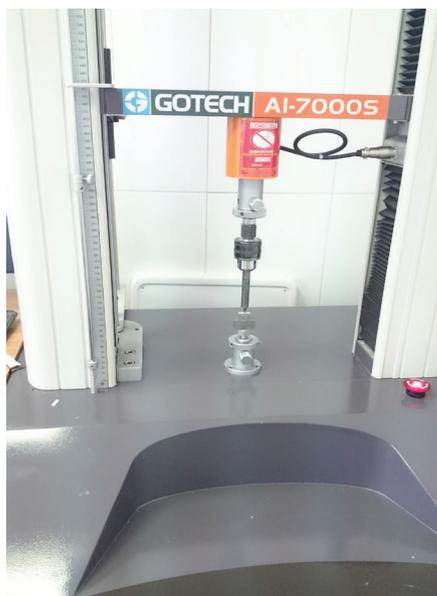
**Рис. 2.** Универсальная испытательная машина GOTECH AI 7000S (рабочий стенд).
