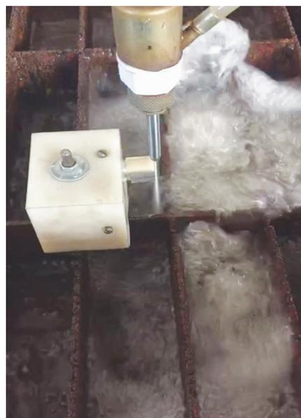
Рис. 1. Процесс гидрорезки блока.
